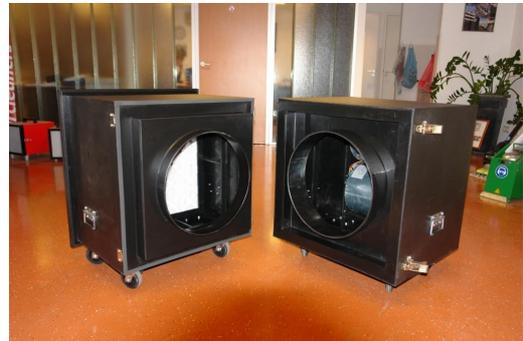
Grâce à un puissant ventilateur la sous-pression est créée, qui aspire l'air pollué de la zone par un filtre absolu HEPA. L'application d'un préfiltre rallonge considérablement la durée de vie du filtre HEPA. Le préfiltre peut être remplacé dans "la zone contaminée", sans que pour cela la machine doive être arrêtée.
